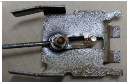
Abbildung 7 Gehäuseoberteil mit Anschlägen und Schleifer
