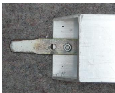
Abb. 6 Holm mit Metallzungen von oben
