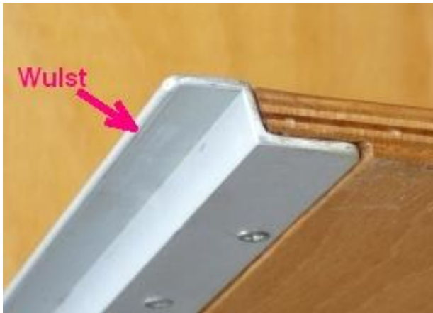
Abb. 29 mittlere Bretteinheit mit Z-Profil
