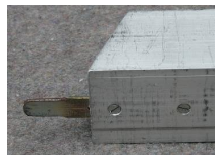
Abb. 7 Holm mit Metallzungen von unten
