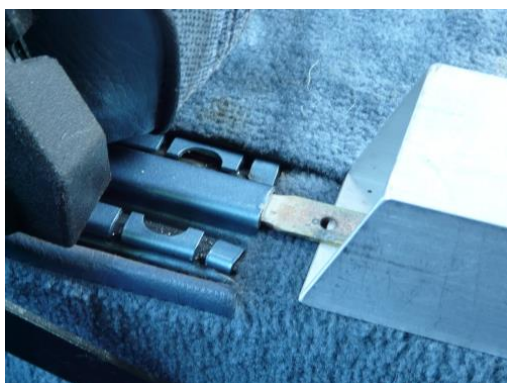
Abb. 14 Holm mit Metallzunge ins U-Profil der Rastschiene des Vordersitzes eingesteckt
